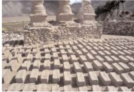
An der Sonne sind die Ziegel in wenigen Tagen trocken und verwendbar
